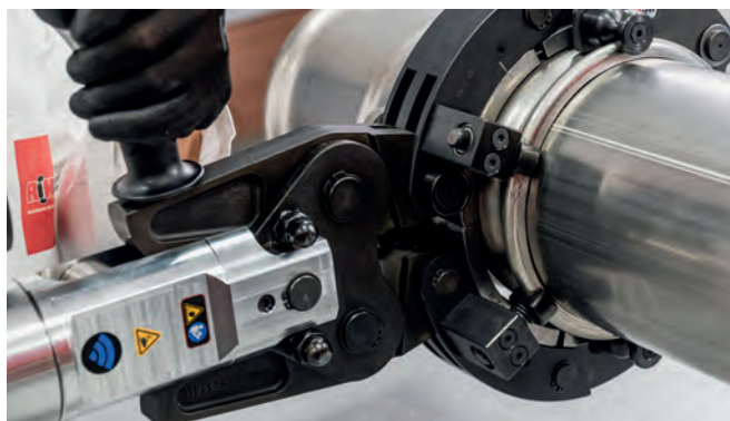
Figura 40 - Assemblaggio pressatura n°2
